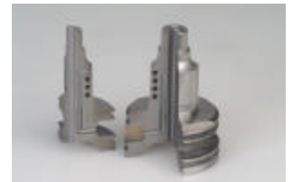
Werkzeugeinsatz aus Warmarbeitsstahl mit konturnaher Kühlung
