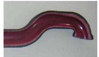
„2K-WIT“-Kühlwasserrohr für eine optimale Funktion des Innen- und Außenrohrs aus glasfaserverstärktem PA (außen) und PP (innen)
