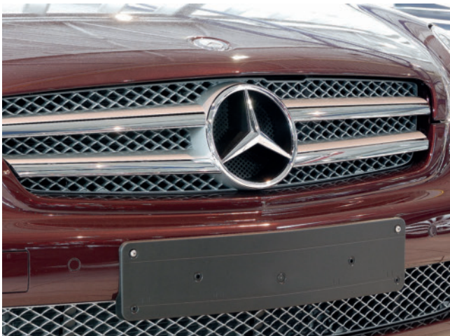
Bild 9. Der Kühlergrill mit Rautengitter wird aus einem Metallic-Compound kostengünstig in einem Arbeitsschritt gefertigt (Foto: SPE)
